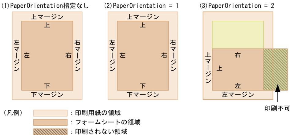
図 3-2 A4 横向きで作成されたフォームシートを A4 用紙に印刷した場合の出力結果
