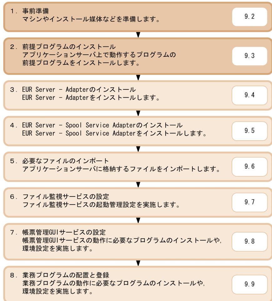
図 9-1 帳票サーバとは別にアプリケーションサーバを構築する場合の構築の流れ
