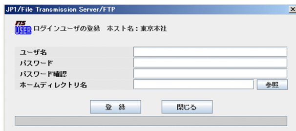
図 4-8 ログインユーザを登録するためのダイアログボックス
