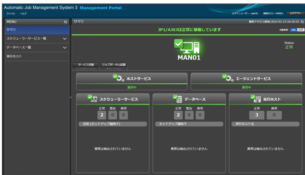
図 13-26 Web GUI (マネジメントポータル) で JP1/AJS3 の状態を確認する場合の画面例
