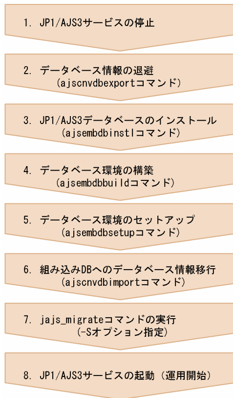
図 8-3 データ移行作業の流れ (高度な設定)
