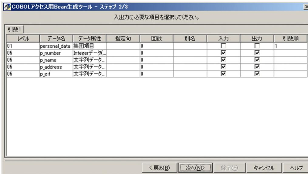
「COBOL アクセス用 Bean 生成ツールステップ 2/3」画面には、「COBOL アクセス用 Bean 生成ツールステップ 1/3」画面で指定した登録集原文を COBOL アクセスが解析した情報が引数ごとにテーブル表示されます（これ以降、このテーブルのことを「パラメータテーブル」とします）。
