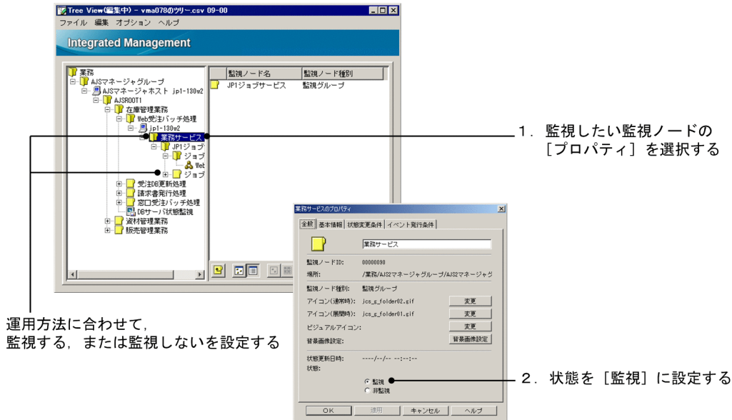
図 5-5 [全般] ページにより、監視ノードの監視状態を「監視」にする例
