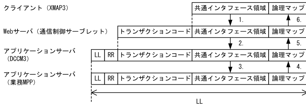
図 9-8 Cosminexus と VOS3 DCCM3 で連携するシステムで扱う送受信データの関係
