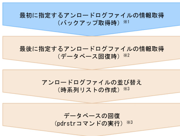
図 3-13 データベース回復時に使用するアンロードログファイルの特定手順
