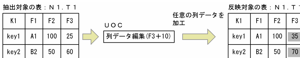
図 3-10 UOC で列を加工して反映する例
