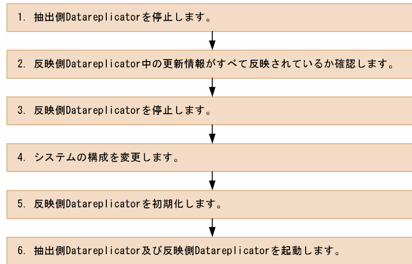
図 6-26 反映側システムの構成変更の手順
