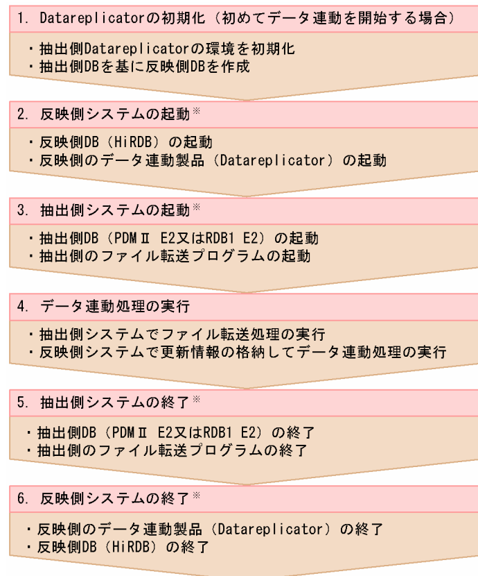
図 6-2 SAM ファイルを使って、メインフレーム側 DB から HiRDB へデータ連動するときの運用手順
