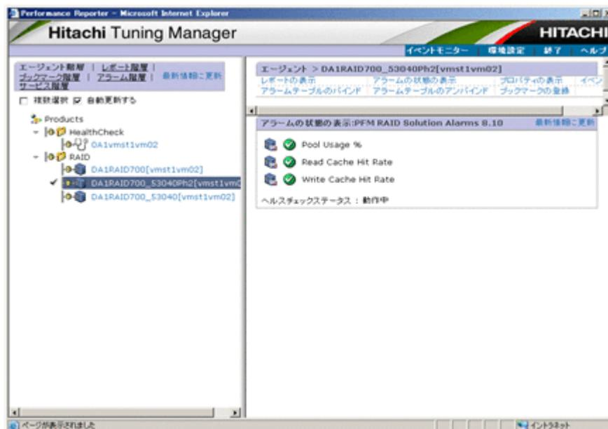
画面左側のナビゲーションフレームに表示されるエージェント階層のアイコンで、各エージェントの稼働状況を確認します。また、このエージェント階層から選択したエージェントに対して、関連レポートの表示やアラームの状態、イベント履歴の確認などの操作を行います。
