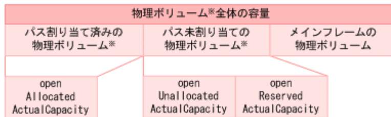
図 5-2 属性の関係 (物理ボリュームおよび仮想ボリュームの容量)
