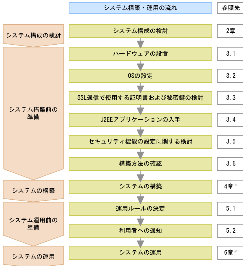
図 1-3 システム構築・運用の流れ
