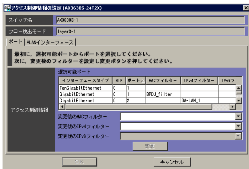
図 14-27 [アクセス制御情報の設定] ダイアログボックス ([ポート] ページ)
