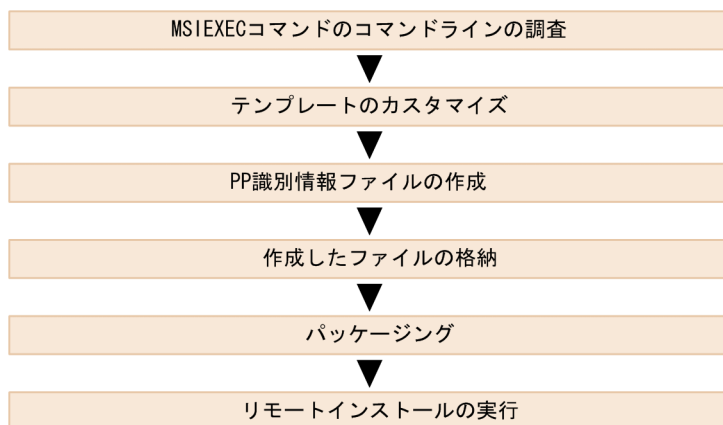
図 E-1 Windows Installer に対応したソフトウェアのリモートインストールの流れ
