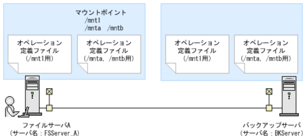
図 4-12：オペレーション定義ファイルの配置例（Solaris で、バックアップ対象がファイルシステムの場合）
