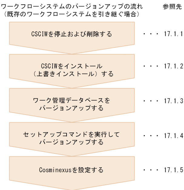
図 17-1 ワークフローシステムのバージョンアップの流れ（既存のワークフローシステムを引き継ぐ場合）
