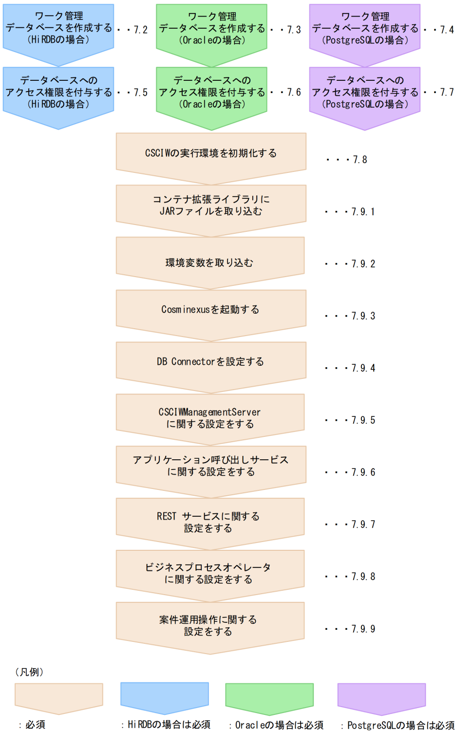
図 7-1 ワークフローシステムの構築の流れ
