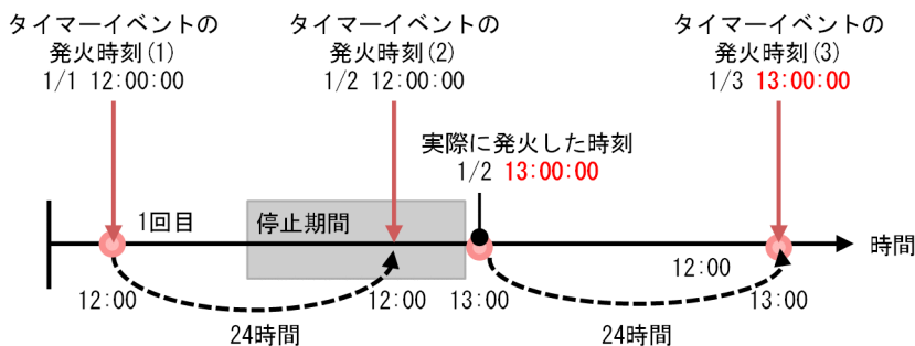
図 1-111 アプリケーション呼び出しサービスの停止によるイベント発火時刻のずれ (間隔方式の場合)
