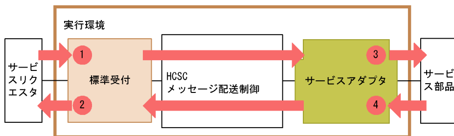
図 7-10 性能解析トレースの取得ポイント（単体サービス実行時）
