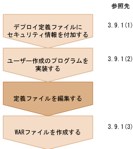
図 B-1 サーバ側の移行手順
