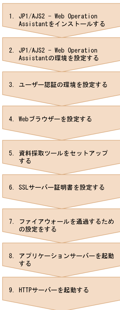
図 3-2 JP1/AJS2 - Web Operation Assistant 側のインストールとセットアップ処理の流れ
