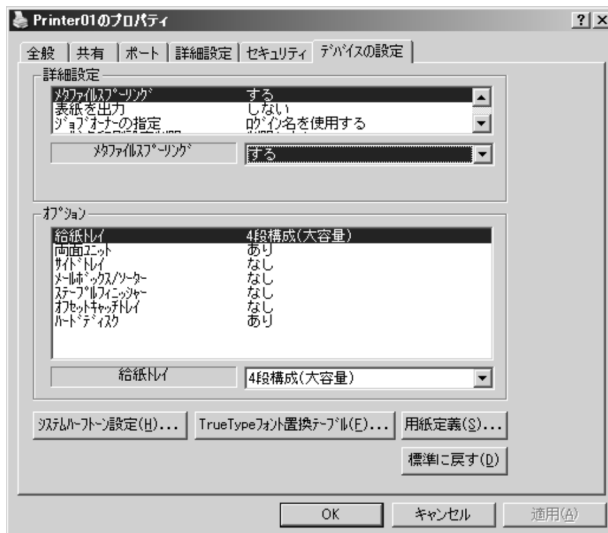
図 5-14 プリンタプロパティ ([ デバイスの設定 ] タブの EMF スプーリング設定例)
