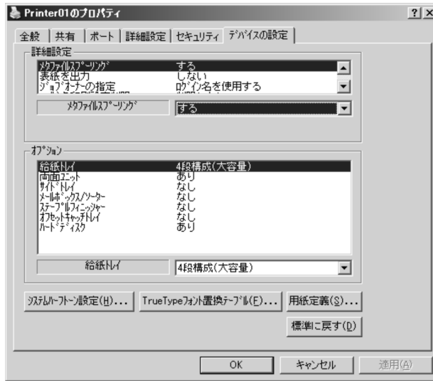
図 5-30 プリンタプロパティ ([ デバイスの設定 ] タブの EMF スプーリング設定例)
