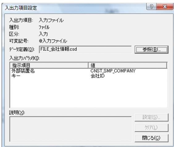
[ 入出力項目設定 ] ダイアログには、[ 入出力 ] タブで選ばれた入出力項目と、それに関する情報が表示されます。これらの情報を基に、AP 中で使用するデータ定義ファイルを選びます。また、選んだデータ定義ファイルを修飾する情報も指定できます。
