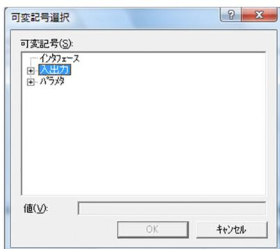
[可変記号選択] ダイアログには、可変記号の一覧が表示されています。プロシジャの引数として使用したい可変記号を選びます。
