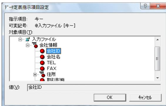
[ データ定義指示項目設定 ] ダイアログでは、[ 入出力 ] タブで選ばれた指示項目が表示されます。指示項目に設定する値は、データ定義ファイルの項目から選びます。ただし、[ 入出力 ] タブで定義されていないデータ定義ファイルは選べません。
