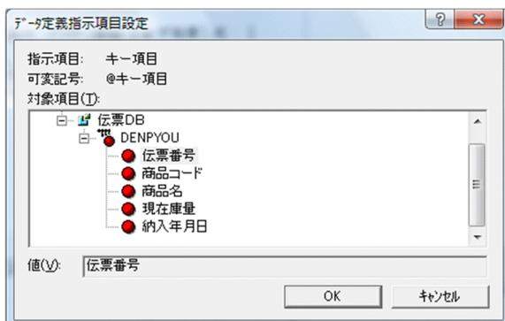
[ データ定義指示項目設定 ] ダイアログでは, [ パラメタ ] タブで選ばれた指示項目が表示されます。指示項目に設定する値は, データ定義ファイルの項目から選びます。ただし, [ 入出力 ] タブで定義されていないデータ定義ファイルは選べません。
