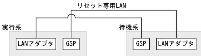
パーティショニングによって、幾つかのパーティション間で系切り替え構成にする場合、一つのパーティションが一つの系になります。したがって、各パーティションからリセット専用 LAN に接続する必要があります。パーティション間で系切り替え構成にする場合のリセット専用 LAN の接続構成を、次の図に示します。
