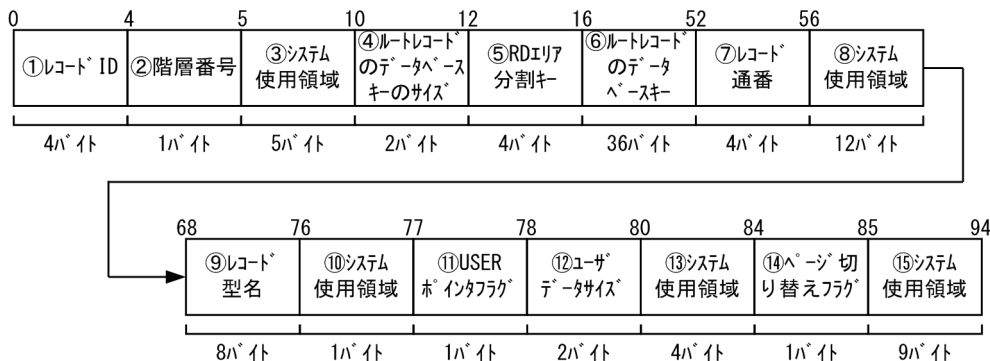
図 13-8 プリフィクス部のデータ形式 (4V FMB の SDB データベースの場合)
