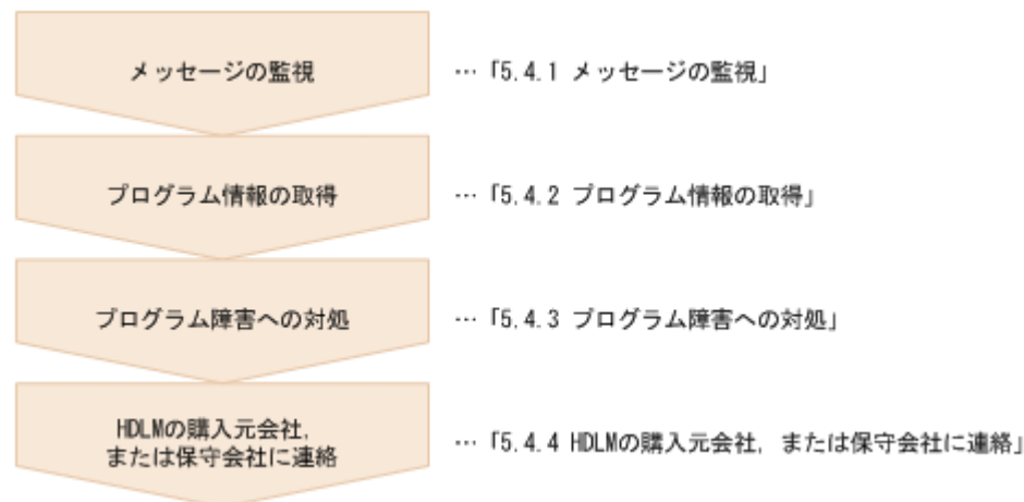
図 5-3 プログラム障害時の対処手順
