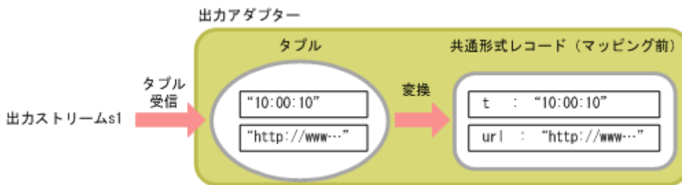
図 16-38 出力アダプターでのタプル受信の例
