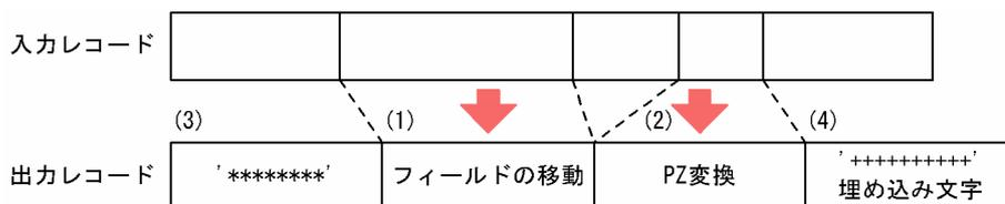
(1)入力レコードの指定位置から指定した長さのフィールド（内の情報）を、出力レコードの指定位置へ移す。
